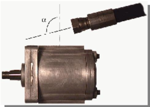
La **inclinación** del empalme que busca no tiene nada de habitual, por lo que deben « amañar », adaptar más o menos una solución con racores típicos y eso, muchas veces en **detrimento** de la fiabilidad y del coste final de la instalación.
